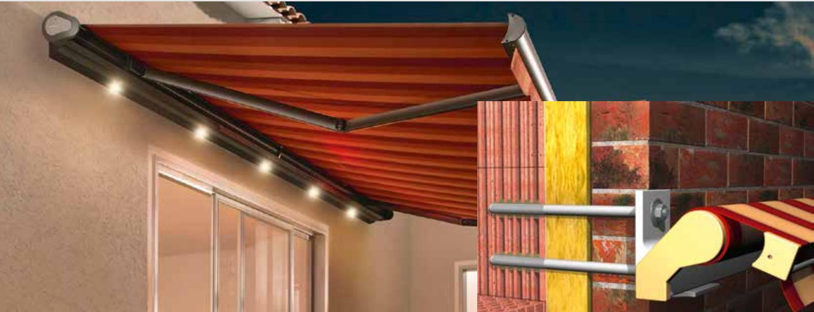
Das Injektionssystem besteht aus einem Set (Durchsteckankerhülse FIS HK, Ankerstange FIS A und dem Hochleistungsmörtel FIS V).
